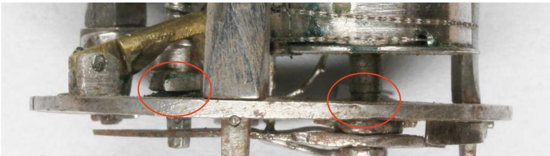
Abbildung: Lager der Federhauswelle und Schneckenwelle
