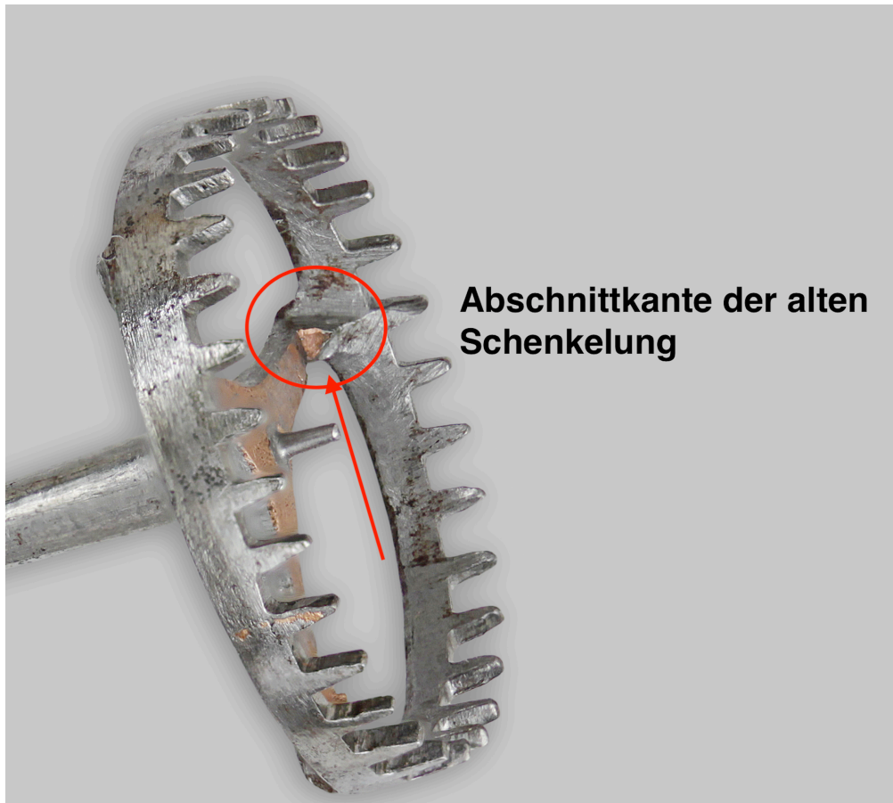
Abbildung: Umgearbeitete Radspeichen am Kronrad
