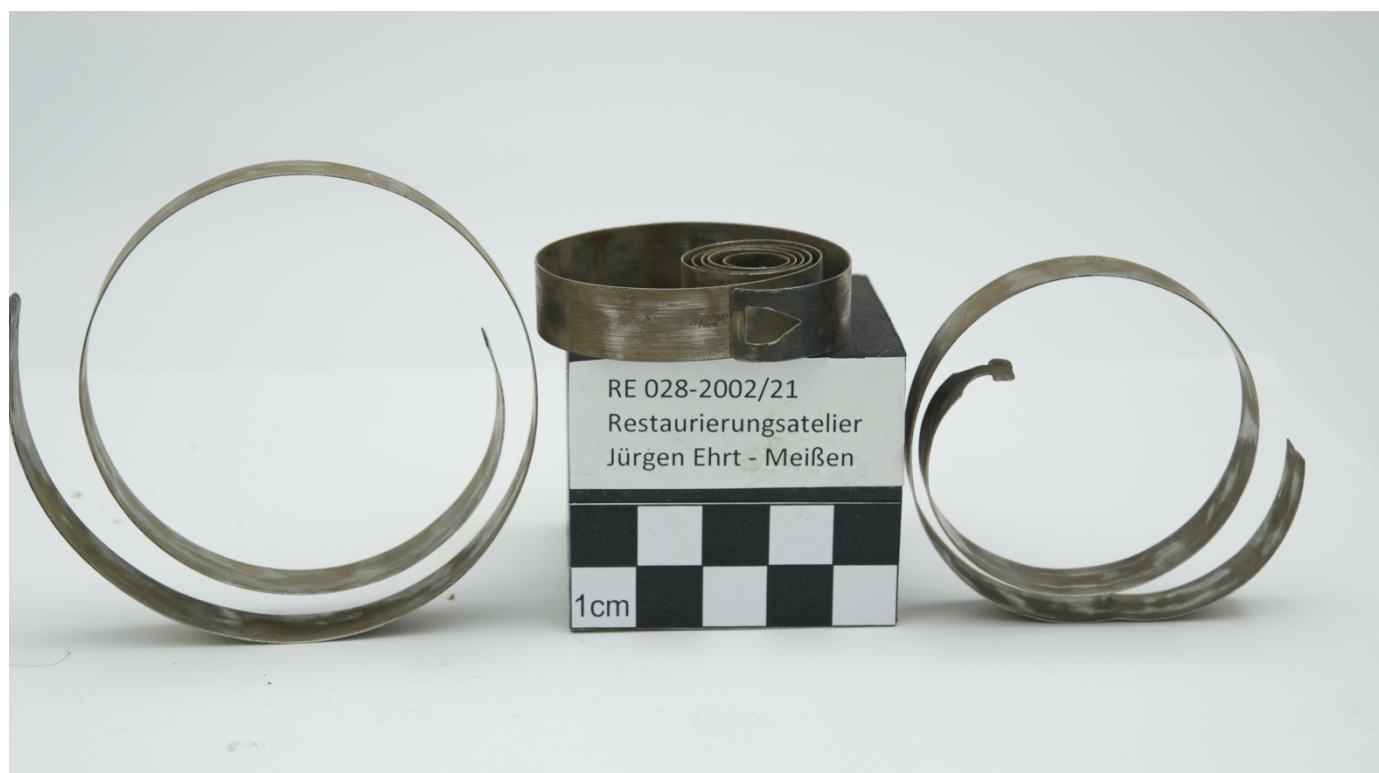
Abbildungen: Zerbrochene Triebfeder
