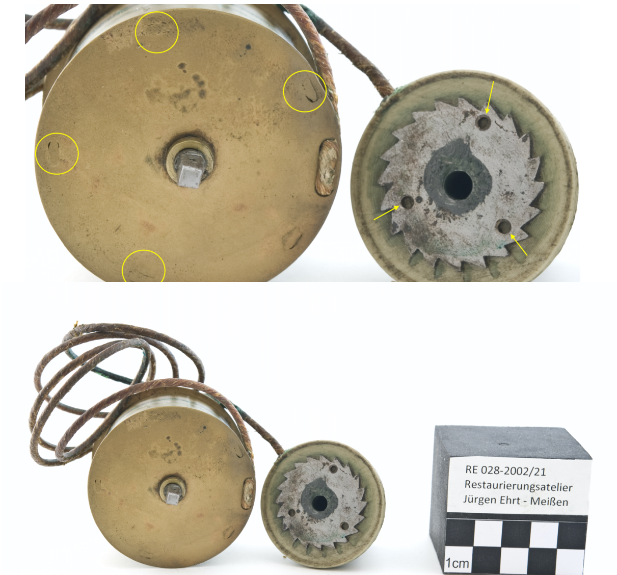
Abbildungen: Federhaus mit Schnecke, Darmsaite und Schneckengesperr vor der Restaurierung
