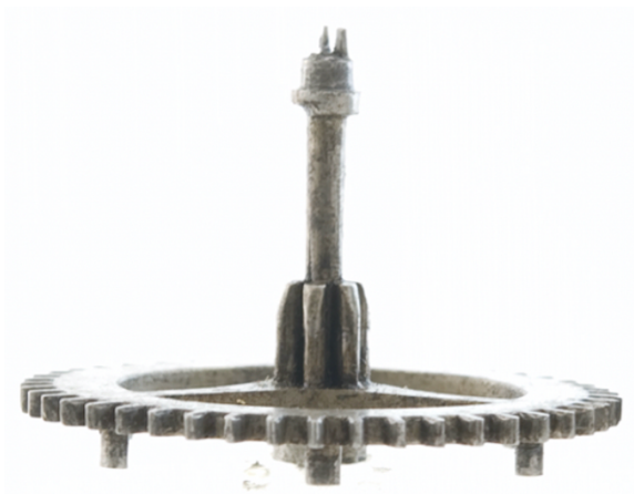
Abbildungen: Triebstecken-Bruch am Hebnägelrad
