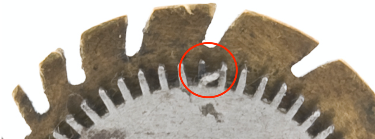
Abbildungen: Trieb Schlossscheibe vor der Restaurierung
