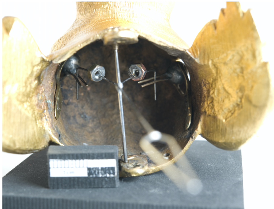
Abbildung: Augensteuerung im Kopf des Elefanten
